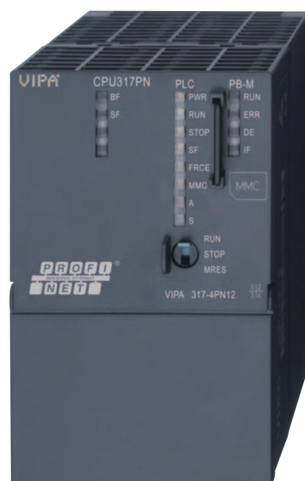
Eine Vipa 317-4NE12 interagiert als zentrale Steuerung mit 13 Stück Vipa 315-2AG12 in den Modulen der Anlage.
